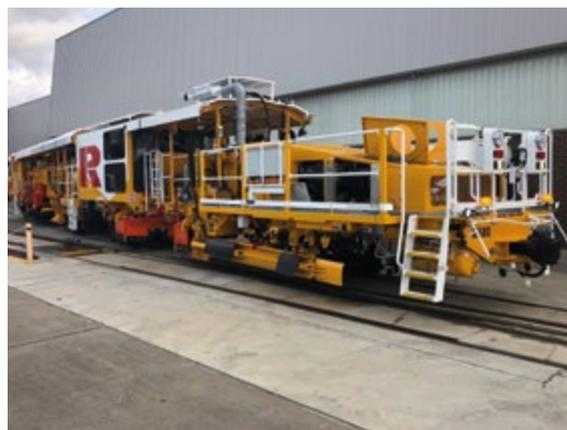
Während der Erprobung wurde die Maschine strengen Tests gemäss australischen Normen unterzogen. Hierzu gehören Bremsentests bei hohen Geschwindigkeiten, Hochgeschwindigkeitsfahrten mit 110 km/h und Feststellbremsentests auf dem steilsten Gefälle des Schienennetzes von Sydney Trains. Nun ergänzt die SSP 303 als Planiermaschine für Weichen die Stopfmaschine M865 Unimat 08/275 3S an der Ostküste Australiens.
