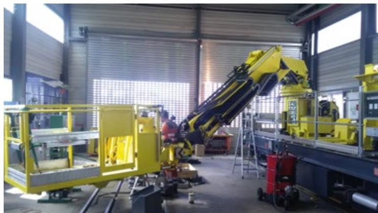
Schwere Instandhaltung: Funktionsprüfung Hebebühne an einem Kundenfahrzeug
