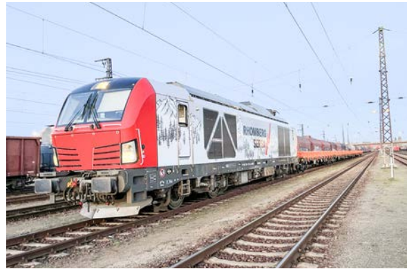
↳ Vectron Dual Mode Antrieb: elektrisch über Fahrdrat; Dieselmotor MTU Höchstgeschwindigkeit: 160 km/h Länge: 19,98 m über Puffer Traktionsleistung: 2 000 kW elektrisch und Dieselmotor Gewicht: 90 Tonnen
