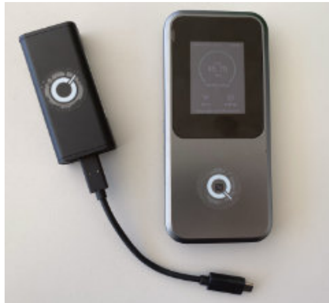
Dongels zur Einbindung eines nicht-5G-kompatiblen Geräts in ein 5G Campusnetz
